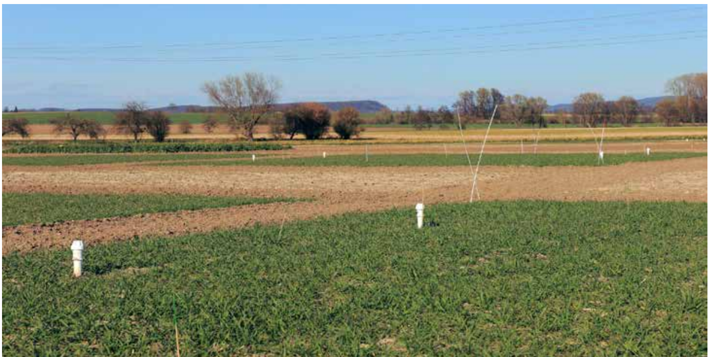
Röhren (weiße Rohrenden im Foto) in den Weizen-Parzellen des Systemversuchs Fruchtfolge in Harste ermöglichen regelmäßige Messungen des Bodenwassergehaltes (FDR-Verfahren) bis in eine Tiefe von 1,6 m.
