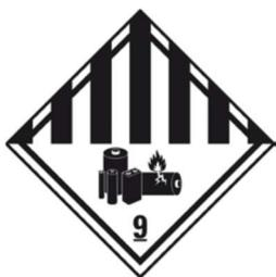
Lithium-Ionen-Akkus oder Geräte, die solche enthalten, können bereits ab Temperaturen von 70° C Schaden nehmen, was zu Brandgefahren führen kann. Daher dürfen sie nicht über einen längeren Zeitraum intensiver Sonneneinstrahlung oder anderen Hitzequellen ausgesetzt sein.
