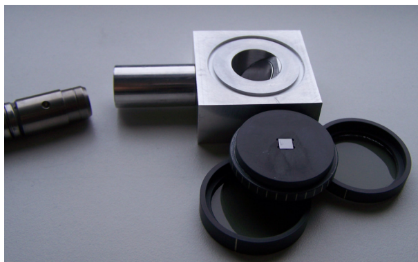
Abb. 3.9.: Bestandteile der optischen Spannungsmessung: Vorne die Halterung mit zwei linear Polarisatoren und eingesetztem Diamanten, hinten der Block mit eingelassenem Spiegel und Röhre für den Lichtleiter, links der Lichtleiter selber.
