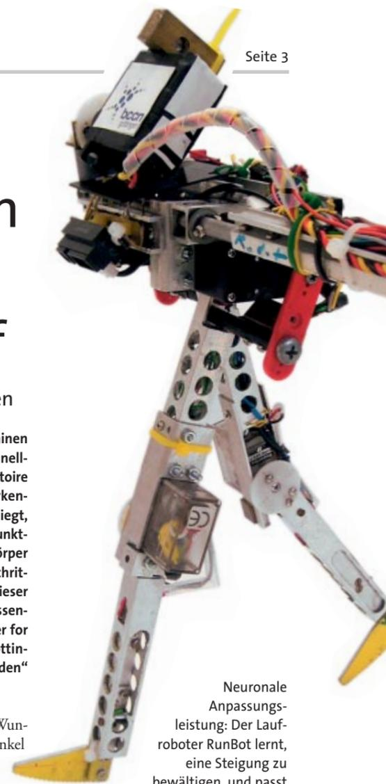
Neuronale Anpassungsleistung: Der Laufroboter RunBot lernt, eine Steigung zu bewältigen, und passt seinen Gang punktgenau den Gegebenheiten an (Foto: BCCN)
