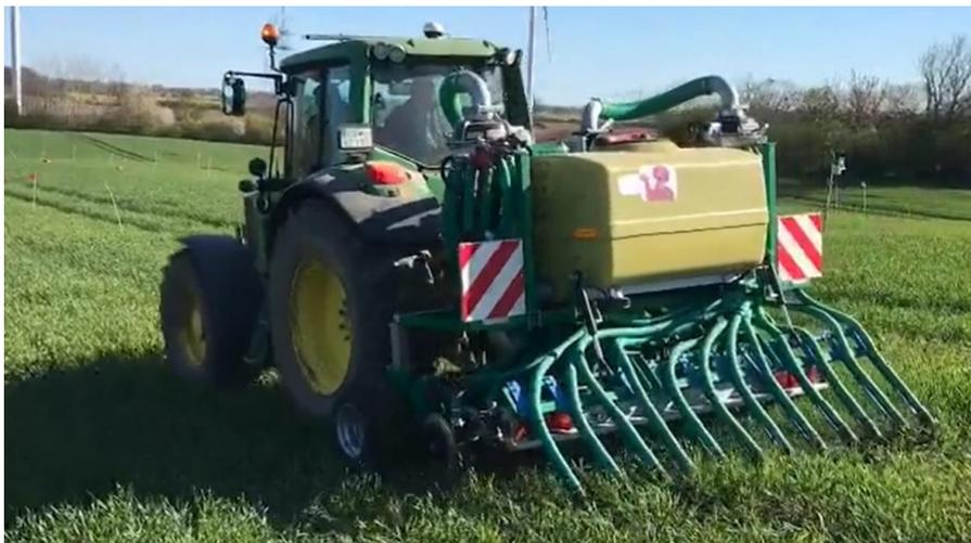
Abbildung 2: Der im NitriKlim-Projekt verwendete Gülleverteiler. Mit seinen 12 Schleppschuhen kann die Gülle schlitzförmig bodennah in randomisierten Versuchspartzen ausgebracht werden, um eine hohe N-Effizienz und geringe N-Verflüchtigung zu erreichen.
